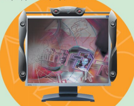
Четыре датчика по бокам монитора обеспечивают высокую точность определения перемещений.
